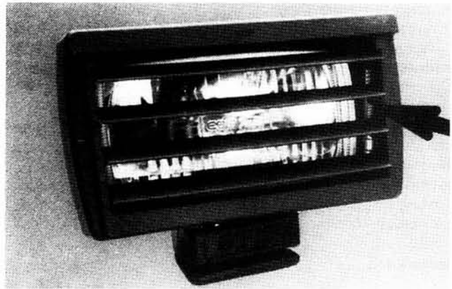
Bild 10b. Nebelscheinwerfer mit Steinschlag-Schutzlamellen, betätigt mit Memory-Stellelement (Werkbilder Raychem)
