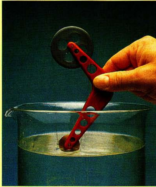
Die „Wang-Memory-Maschine“ läuft wie von selbst, solange das Wasser am kleineren Rad heiß genug ist.
